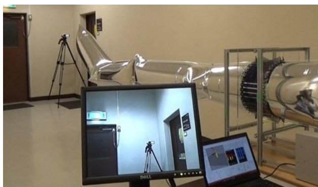
図 10 先端にカメラを搭載し、カメラから周囲の状況を確認する実験の様子
